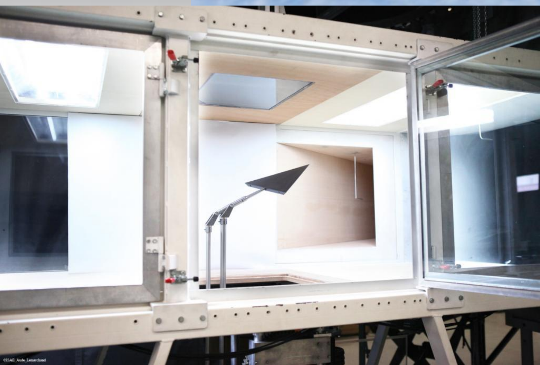
Soufflerie subsonique SABRE du département DAEP de Supaero
